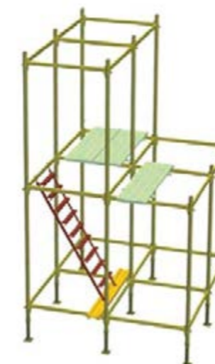
Установка лестниц для подъема рабочих
