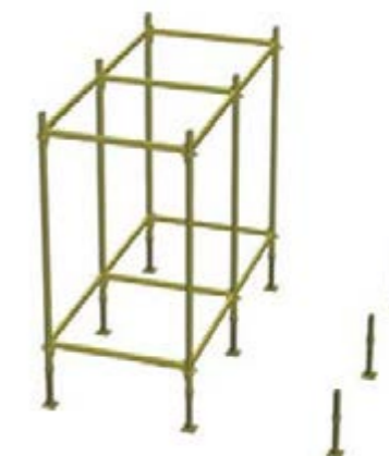
Установка и фиксация стоек
